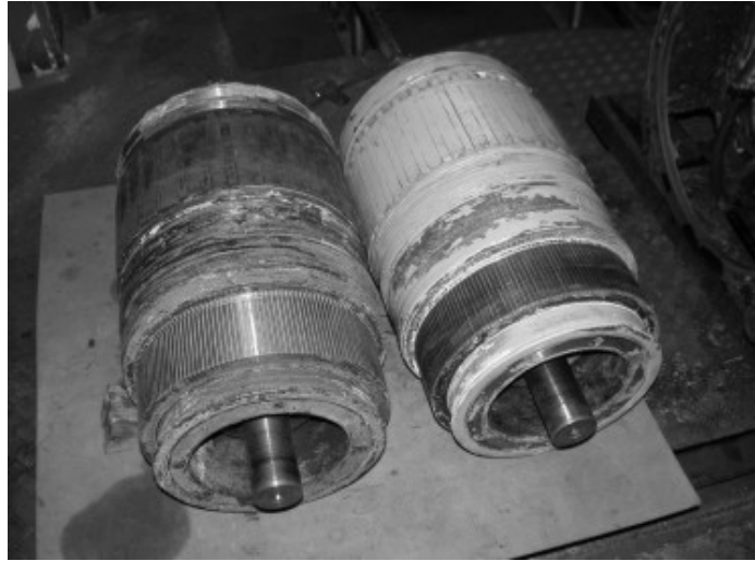
Die beiden Rotoren der Traktionsmotoren des "Melchnauerli" nach dem Neuimprägnieren (Foto: © FSS; Martin Strobel).
