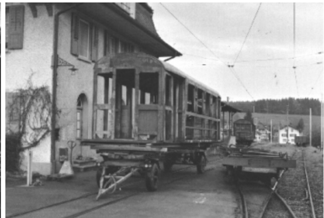
Der Kasten des "Melchnauerli" ist zum Abtransport nach Zollbrück bereit. Daneben steht das Untergestell, bevor es in die Remise geschoben wird (Foto: © FSS; Reto Steiner).
